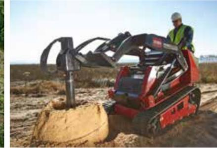
**HIGH-TORQUE AUGER POWER HEAD**
