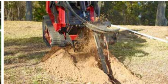
**HIGH-TORQUE TRENCHER HEAD**
