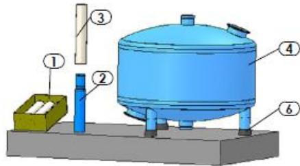
**Paso 3** – Coloque la tapa de goma (6) en la parte de abajo de la pata de extensión (2).
