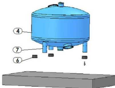
**Paso 4** – Monte las patas de extensión(2) a las patas del filtro (7) usando un montacargas acolchado para elevar el filtro o inclinándola
