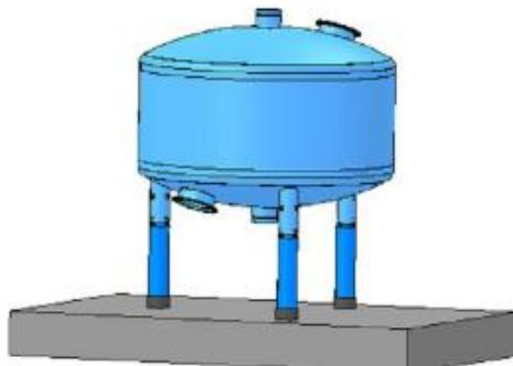
**Paso 2** –Cuidadosamente eleve el filtro de media (4) con \*\*montacargas acolchado o inclínelo, y remueva las tapas de goma (6) de la pata del filtro (7).
