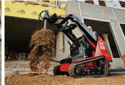
**HIGH-TORQUE AUGER POWER HEAD**
