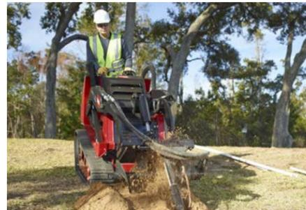
**HIGH-TORQUE TRENCHER HEAD**
